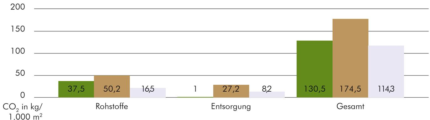
Für sortenreine Verpackung in natürlicher Optik ist Papierklebeband unschlagbar, für eine ausreichend hohe Reißkraft ist ein vergleichsweise hoher Materialeinsatz (Gesamtstärke) erforderlich, was sich in einem vergleichsweise höheren CO<sub>2</sub>-Wert widerspiegelt.
